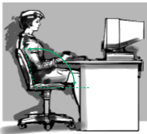
Figura 12 - Postazione di lavoro corretta al videoterminale: la schiena è leggermente inclinata all'indietro
