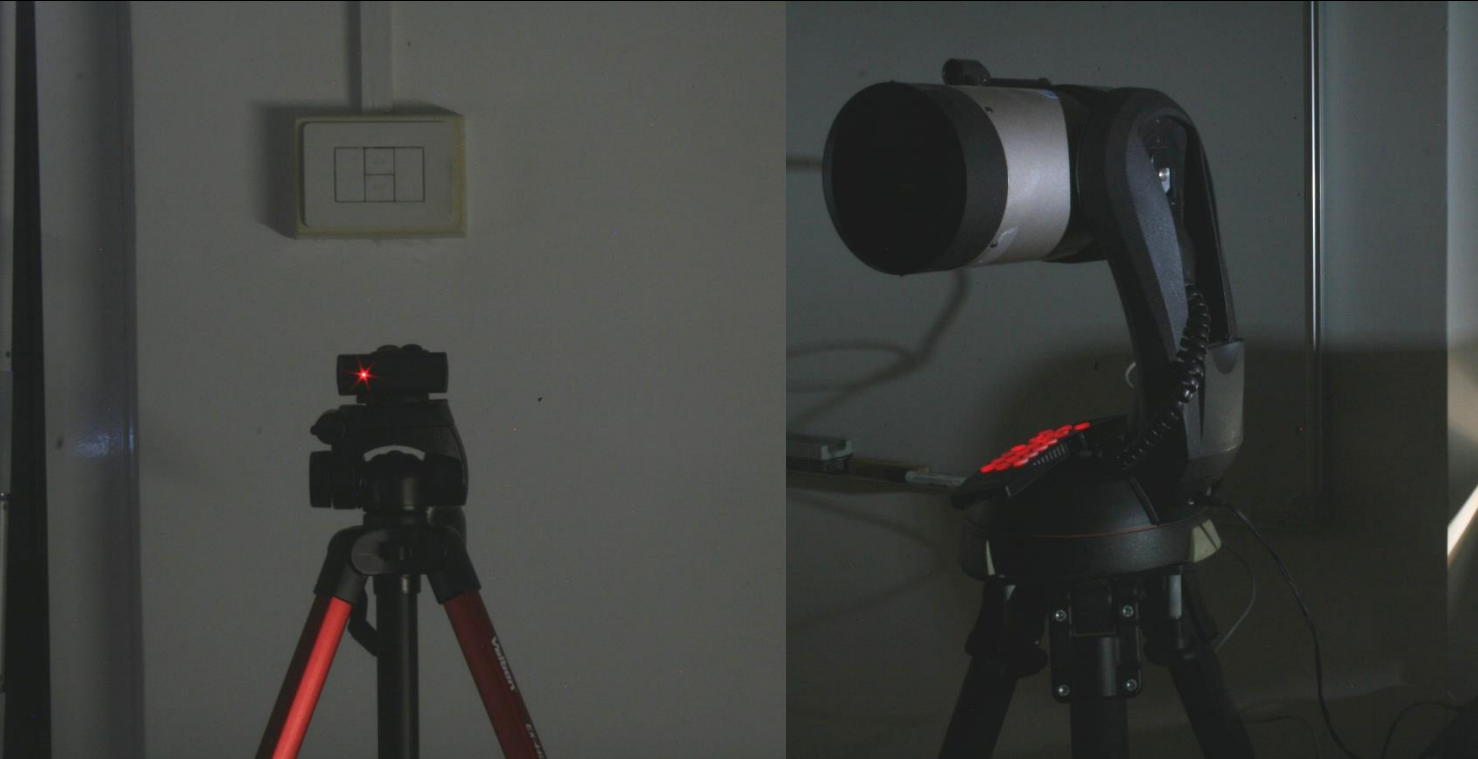
Stella artificiale : fibra ottica \varnothing = 50 \mu\text{m}
