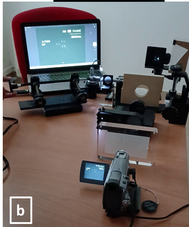
Figg. 33 a) – b) – c): il modo di misurare di Bessel
